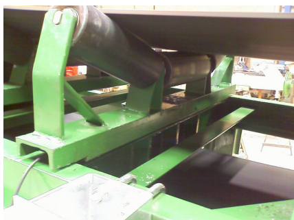
Rodillos de pesaje sobre el bastidor
